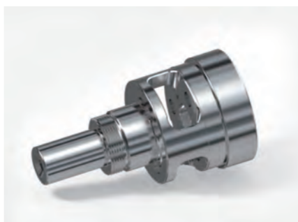
出力轴为研磨光面处理, 与油封搭配确保最低摩擦系数和启动负载
